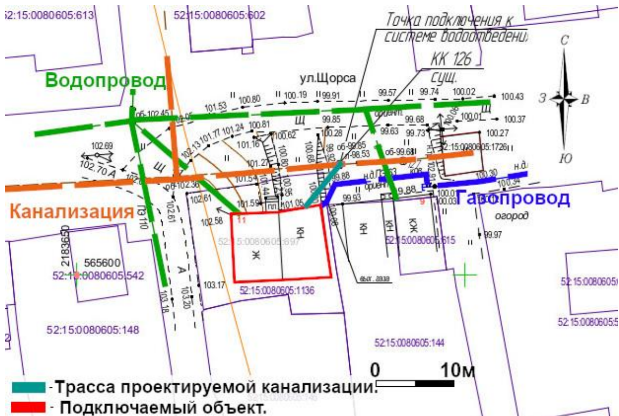
Ил. 24. Схема подключения коммуникаций с указанием проектируемого вывода водоотведения. Предоставлена заказчиком.
